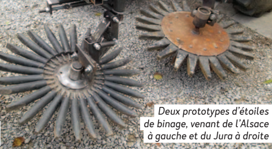
Étoiles de binages autoconstruites avec l'Atelier Paysan dans le Jura
