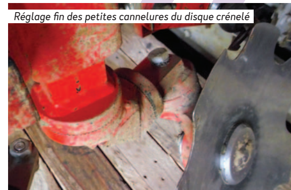
Disque crénelé en fixe, lame plate munie de deux tiges en intercep, et patte d'oie étroite
