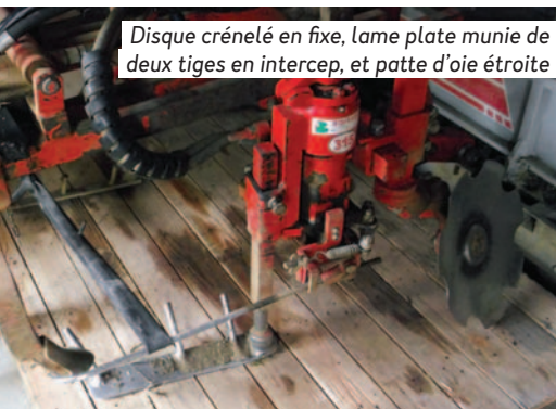
Réglage fin des petites cannelures du disque crénelé
